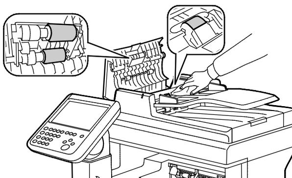
**Nota:** Se os rolos do alimentador automático de originais em F/V e a almofada de separação ficarem manchados com toner ou restos de materiais, eles podem causar manchas nos documentos. Para remover manchas, umedeça um pano macio sem fiapos com água ou detergente natural neutro.
