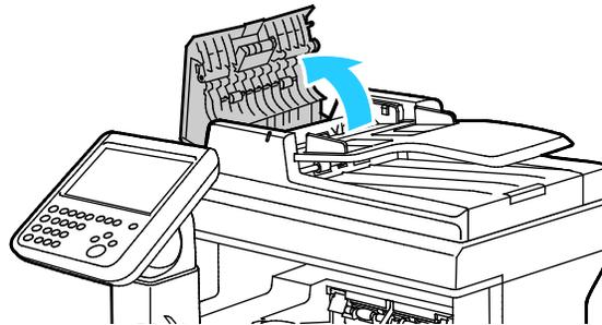
3. Se o papel está atolado na saída do alimentador automático de originais em F/V, puxe para forme conforme ilustrado.
