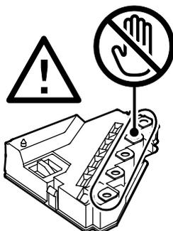
4. Coloque o cartucho de resíduos removido em uma superfície plana
