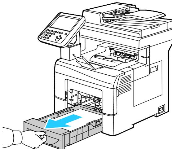
4. Para remover a bandeja, levante ligeiramente a dianteira e puxe-a para fora da impressora.
