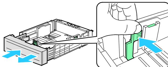
4. Para comprimir a bandeja para papel mais curto, com uma mão, segure a parte traseira da bandeja. Com a outra mão, na parte dianteira da bandeja, pressione a trava de liberação e empurre as extremidades para dentro até que travem.
