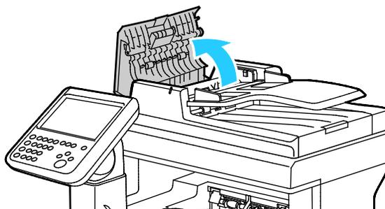
2. Com um pano limpo, sem fiapos, umedecido com água, limpe os rolos de alimentação e almofada de separação até que fiquem limpos.
