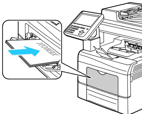
**Nota:** Não coloque papel acima da linha de preenchimento máximo. Sobrecarregar a bandeja pode causar atolamentos na impressora.
