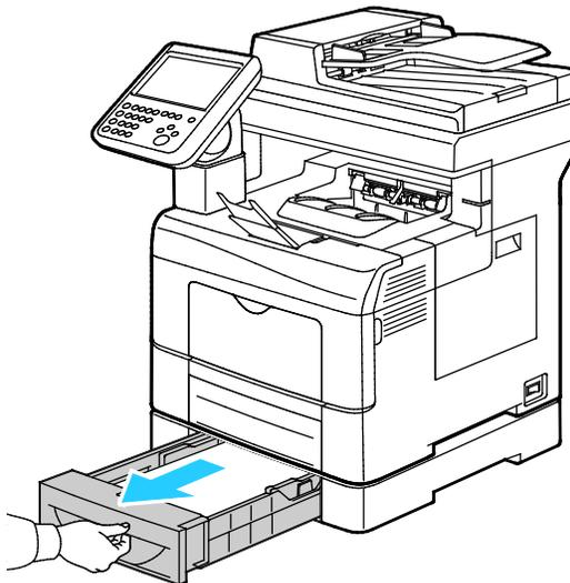
2. Para remover a bandeja, levante ligeiramente a dianteira e puxe-a para fora da impressora.
