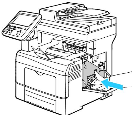
**Nota:** Se o cartucho de resíduos não se encaixar no lugar de modo adequado, verifique se a correia está completamente inserida.
