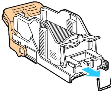
8. Introduzca la abrazadera en la dirección señalada hasta que encaje en la posición de bloqueo.
