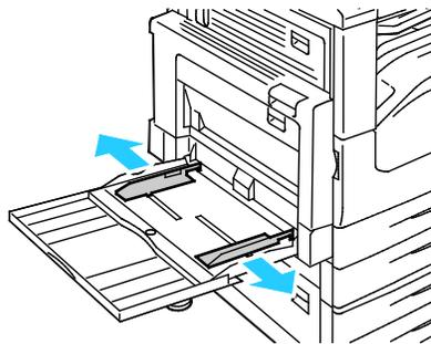
3. Coloque los sobres cara abajo con las solapas cerradas:
