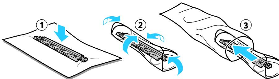
8. Instale en la impresora el rodillo de transferencia nuevo como se muestra. Empuje hacia abajo el rodillo de transferencia hasta que encaje en su lugar.
