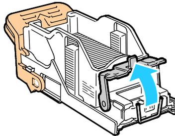
4. Quite las grapas atascadas (1) y baje la abrazadera en la dirección señalada hasta que encaje en la posición de bloqueo (2).
