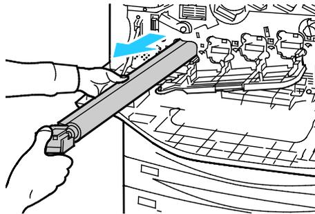
3. Extraiga el material de embalaje del extremo del cartucho de cilindro nuevo.
