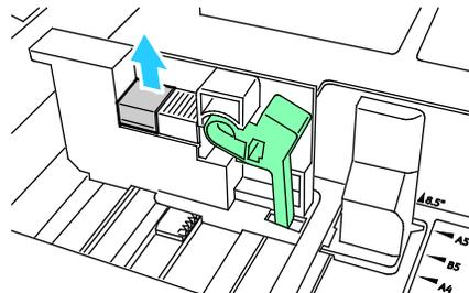
3. Para enganchar el bloqueo de ajuste, presione las palancas y deslice el bloqueo de la guía hacia la izquierda como se muestra.
