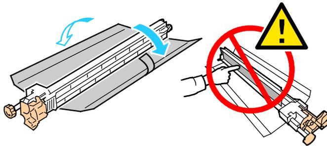
8. Sujete el nuevo limpiador de la correa de transferencia con la mano izquierda y deslícelo en la abertura hasta que se detenga.
