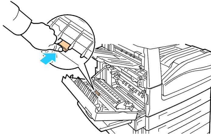
6. Extraiga el rodillo de transferencia usado de la impresora
