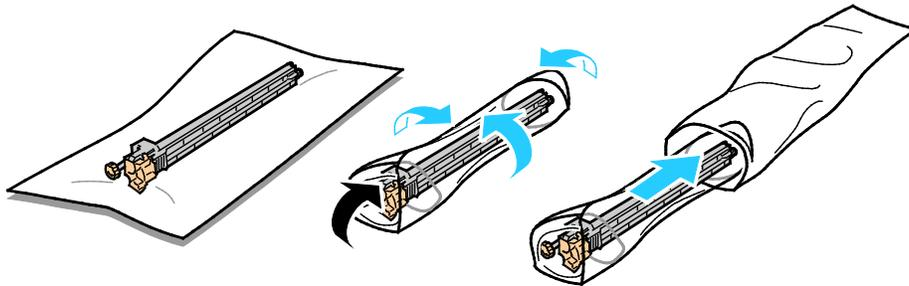
7. Retire la cubierta protectora del limpiador de la correa de transferencia nuevo.
