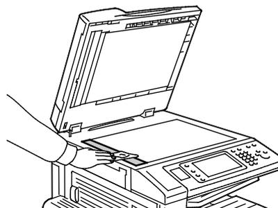
2. Para limpiar la cara inferior de la cubierta de originales y el alimentador de documentos, utilice un paño sin pelusa y un líquido de limpieza de Xerox®.
