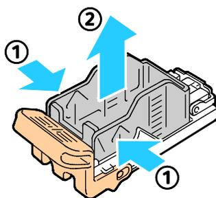
5. Inserte el extremo anterior de la caja de grapas nueva en el cartucho de grapas (1) y baje a continuación el extremo posterior (2).
