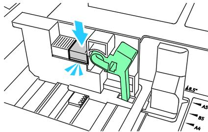
5. Coloque el tamaño de papel personalizado en la bandeja. Las guías de la bandeja se desplazan en incrementos de 1 mm.
