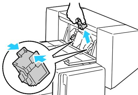
4. Sujete las lengüetas de ambos lados del cartucho de grapas nuevo e insértelo en la posición original en la acabadora.
