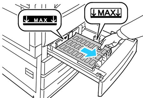
3. Para la alimentación por el borde corto, coloque las etiquetas cara arriba con el borde superior hacia la derecha.
