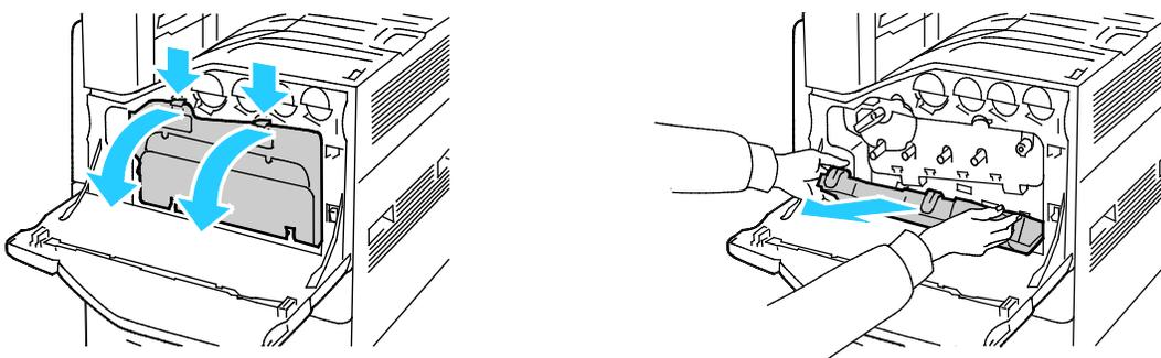
5. Retire varita de limpieza de la ventana del láser de la parte interior de la puerta frontal.
