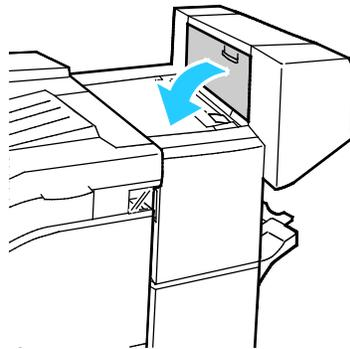
2. Si los cartuchos de grapas no se ven, sujete los paneles verticales de la derecha e izquierda de la abertura y deslícelos hacia el centro.
