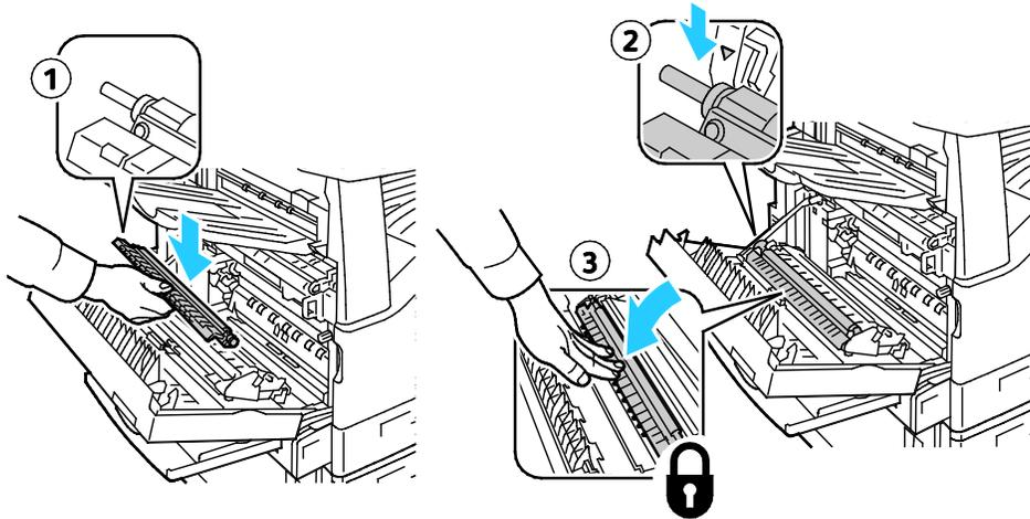
9. Retire la cubierta protectora del rodillo de transferencia.
