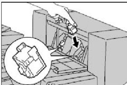
4. Das neue Broschürenheftklammermagazin an den beiden seitlichen Griffen in die Einheit schieben, bis es an der ursprünglichen Position hörbar einrastet.
