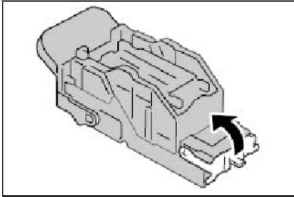
4. Den Hebel vorn am Heftklammermagazin nach oben drücken.
