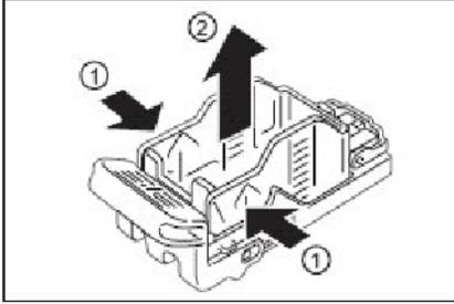
4. Beide Seiten des leeren Heftklammerbehälters zusammendrücken und den Behälter aus dem Magazin nehmen.
