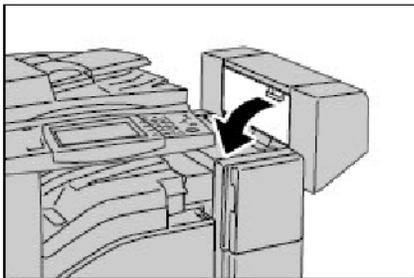
1. Warten, bis das Gerät im Leerlauf ist. Dann die seitliche Abdeckung des Finishers öffnen.
