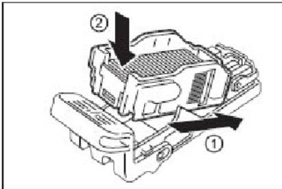
5. Den vorderen Teil des neuen Heftklammerbehälters in das Heftklammermagazin einsetzen und dann den hinteren Teil in das Magazin drücken.
