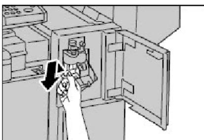
3. Das Heftklammermagazin am orangefarbenen Griff senkrecht aus dem Gerät heben.
