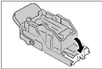
6. Den Hebel vorn am Heftklammermagazin nach unten drücken, bis er hörbar einrastet.
