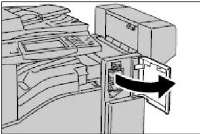
1. Warten, bis das Gerät im Leerlauf ist. Dann die vordere Abdeckung des Finishers öffnen.
