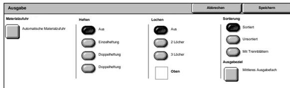
Die Anzeige „Ausgabe“ ermöglicht das Sortieren von Kopien. Wenn der optionale Office-Finisher LX installiert ist, ist die Heftungs-, Lochungs- und/oder Falzfunktion ebenfalls verfügbar.
