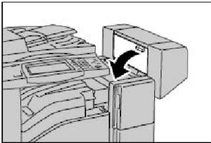
1. Verificare che la macchina si sia arrestata, quindi aprire la copertura laterale della stazione di finitura.
