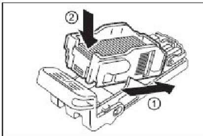
5. Inserire prima la parte anteriore del nuovo contenitore punti nella cartuccia e poi, spingendolo dalla parte posteriore, inserire completamente il contenitore nella cartuccia.
