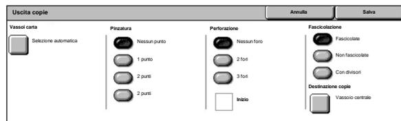
La schermata Uscita copie consente di ordinare le copie in uscita. Se è installata la stazione di finitura per ufficio opzionale LX, sono disponibili anche le funzionalità di pinzatura, perforazione e/o piegatura.
