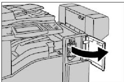
1. Verificare che la macchina non sia in funzione, quindi aprire la copertura anteriore della stazione di finitura.
