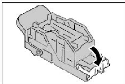
6. Нажмите на передний рычаг картриджа сшивателя вниз до его фиксации.
