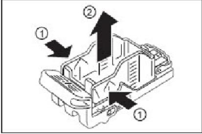
4. Сожмите пальцами пустую оправку для скрепок с обеих сторон и извлеките оправку из картриджа.
