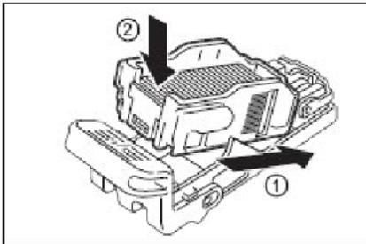
5. Вставьте переднюю сторону новой оправки со скрепками в картридж сшивателя и нажмите на заднюю часть оправки, чтобы вставить ее в картридж.
