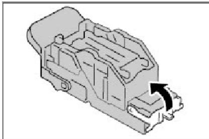
4. Потяните вверх передний рычаг картриджа сшивателя.
