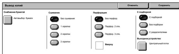
Экран «Вывод копий» позволяет выполнять сортировку копий. Если установлен дополнительный офисный финишер LX, также будут доступны режимы сшивания, перфорирования и/или фальцовки.
