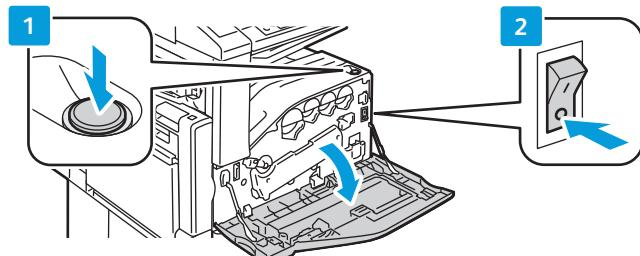
Για επανεκκίνηση του εκτυπωτή, χρησιμοποιήστε το δευτερεύοντα διακόπτη λειτουργίας στο επάνω μέρος του εκτυπωτή. Για πλήρη τερματισμό της λειτουργίας του εκτυπωτή, απενεργοποιήστε το δευτερεύοντα διακόπτη λειτουργίας και, στη συνέχεια, απενεργοποιήστε τον κύριο διακόπτη λειτουργίας πίσω από το μπροστινό κάλυμμα.
