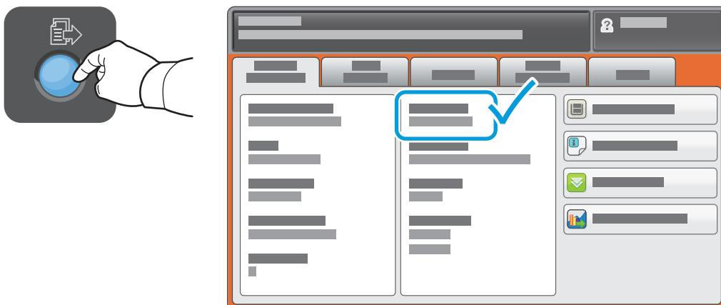
Εάν η διεύθυνση IP δεν εμφανίζεται στην επάνω αριστερή γωνία της οθόνης αφής, πατήστε το πλήκτρο **Κατάσταση μηχανήματος** και ελέγξτε το πεδίο πληροφοριών.
