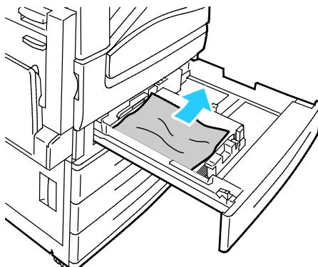
5. Legg uskadet papir i magasinet, og skyv deretter magasinet inn igjen til det stopper. Papirinnstillinger – magasin X vises på kontrollpanelet.
