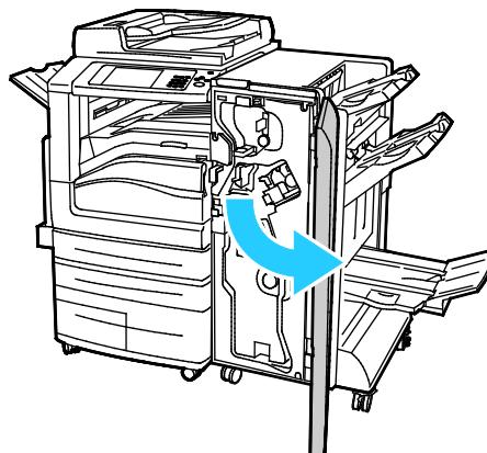
2. Ta tak i heftemodulhåndtaket og dra enheten mot deg til stiftkassetten vises i den øverste kanten av enheten.
