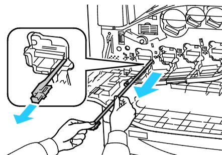
5. Skyv rengjøringsenheten langsomt inn igjen i LED-skrivehodet til den stopper.
