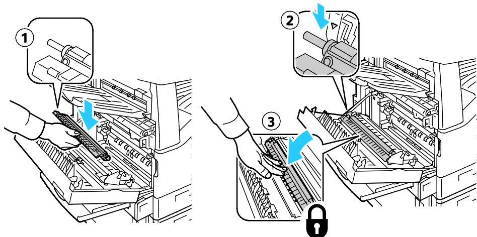
9. Fjern det beskyttende dekseøyet fra overføringsrullen.
