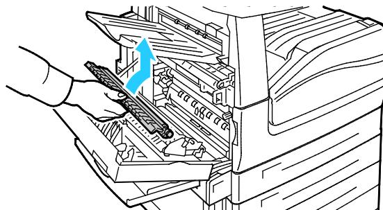
7. Plasser den brukte overføringsrullen i plastposen.
