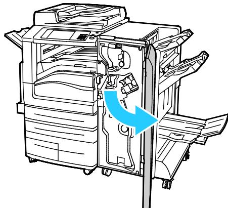
2. Ta tak i heftemodulhåndtaket og dra enheten mot deg til stiftkassetten vises i den øverste kanten av enheten.
