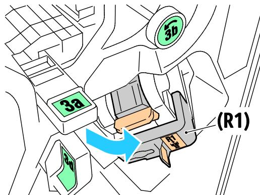
3. Ta tak i den oransje hendelen på stiftkassetten, og ta ut kassetten ved å trekke den bestemt mot deg.
