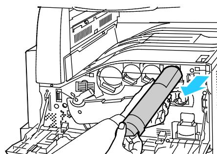
3. Ta den nye fargepulverkassettten ut av emballasjen. Vipp kassetten opp og ned og deretter til venstre og høyre ti ganger.
