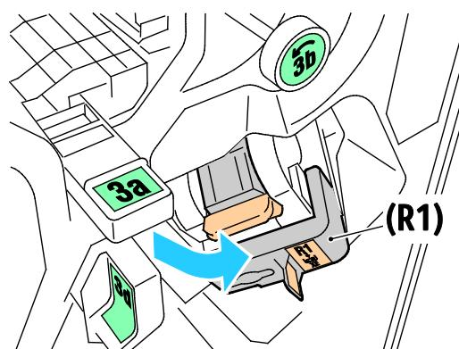
3. Ta tak i den oransje hendelen på stiftkassetten, og ta ut kassetten ved å trekke den bestemt mot deg.
