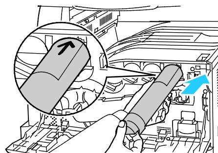
5. Trykk forsiktig på fargepulverkassetten for å sjekke at den sitter på plass.
