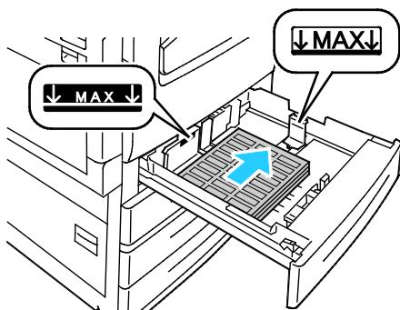
4. Lukk magasinet. Angi papirformat, -type og -farge på kontrollpanelet. Se [Endre papirformat, -type og -farge](#) på side 68 hvis du vil vite mer.
