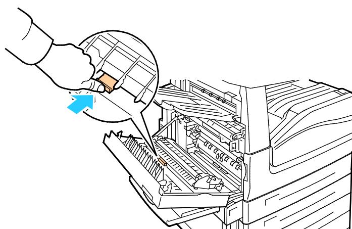
6. Løft den brukte overføringsrullen ut av skriveren.
