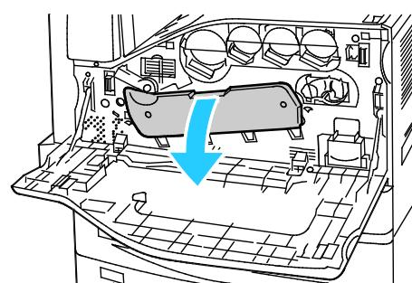
4. Hver av de fire skrivehodene har sitt eget rengjøringsverktøy. Trekk rengjøringsenheten for LED-skrivehodet langsomt ut til de tre prikkene vises.
