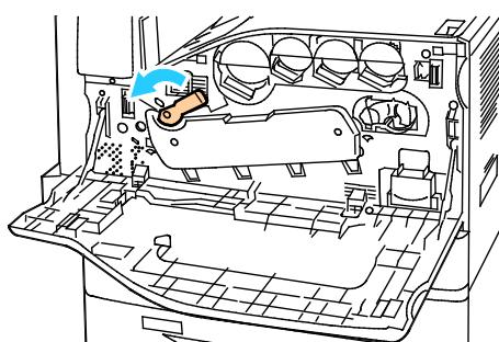
3. Trekk dekslet for trommelkassetten ned til det klikker i åpen stilling.
