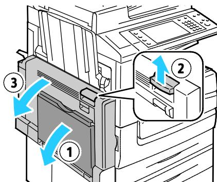
**ADVARSEL:** Området rundt fikseringenheten kan være svært varmt. Vær forsiktig for å unngå at du skader deg.
