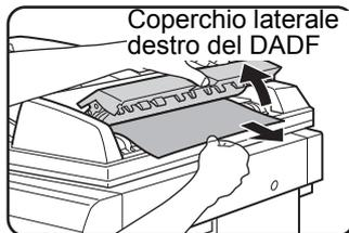
Se l'originale è piccolo (tipo A5) o se l'inceppamento si è verificato nel vassoio d'inversione, aprire il coperchio laterale destro del DADF e rimuovere delicatamente l'originale. Chiudere il coperchio laterale destro del DADF.
