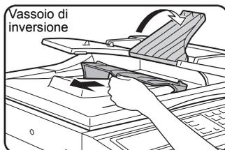
In caso non sia possibile rimuovere facilmente l'originale inceppato dalla zona di uscita, aprire la parte mobile del vassoio DADF e rimuovere il vassoio invertitore, quindi rimuovere l'originale.
