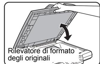
**NOTA:** Non sistemare alcun oggetto sotto la piastra del rilevatore del formato degli originali. Se si abbassa il coperchio della lastra di esposizione con sotto un oggetto, la piastra del rilevatore del formato degli originali potrebbe danneggiarsi e il formato del documento potrebbe essere rilevato in maniera errata.
