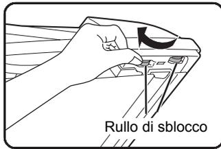
Aprire il DADF e ruotare i due rulli di sblocco nella direzione indicata dalla freccia per far uscire l'originale. Chiudere il DADF e rimuovere delicatamente l'originale.
