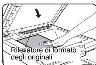
**NOTA:** *Non collocare nessun oggetto sotto il rilevatore del formato degli originali. Si rischia di rovinarlo o di ostacolare il rilevatore del formato.*
