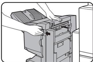
**NOTA:** *Il finitore con pinzatura a sella e la macchina sono collegate sul retro. Fare attenzione quando li si separa.*
