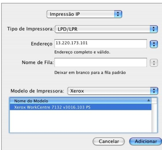
2. Digite o endereço IP ou o nome DNS da impressora no campo Printer Address.
