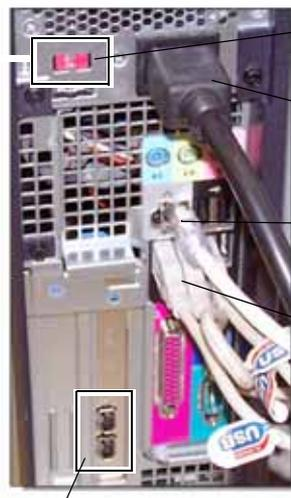
**Interrupteur de sélection 115/230V**
