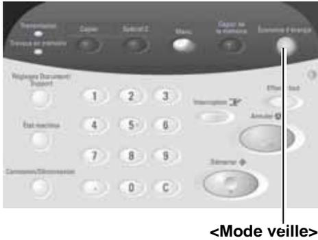
**Méthode manuelle :** La machine étant en mode Économie d'énergie, appuyer sur le bouton <Économie d'énergie> allumé. Le voyant du bouton s'éteint, l'écran tactile affiche le message Préchauffage et la machine commence son cycle de préchauffage.
