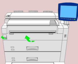
Materialstau an der Zusatzzufuhr.
