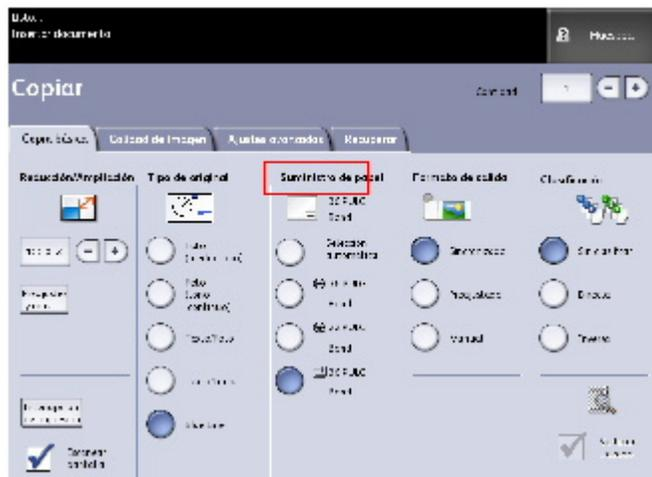
3. Seleccione **Estado y configuración del papel**. Una vez que se selecciona **Estado y configuración del papel**, aparece la siguiente pantalla.
