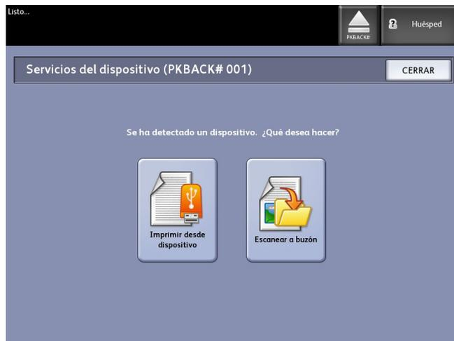
2. Seleccione **Escanear a buzón** y, a continuación, las funciones y ajustes deseados desde las fichas Escanear a buzón, Calidad de imagen y Ajustes avanzados.
