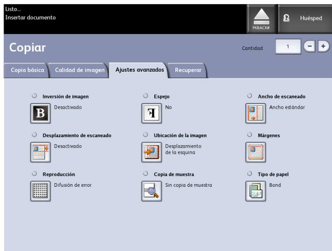
La ficha **Ajustes avanzados** le permite configurar el diseño, el procesamiento y el acabado de la salida de los trabajos. Las opciones se definen a continuación:
