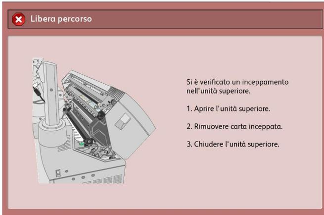
1. Sollevare la leva di rilascio dell'unità superiore per aprire l'unità superiore.
