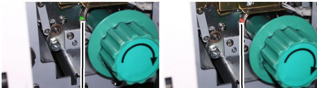
5. Coloque la Cortadora nuevamente en la posición de inicio girando el botón verde de la cortadora hasta que se vea verde dentro de la muesca. La posición de inicio se indica en color verde.
