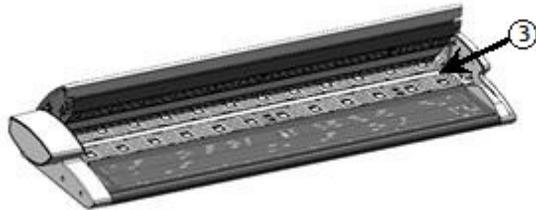
6. Протрите контактный датчик изображения чистой, сухой безворсовой тканью. Когда контактный датчик изображения загрязняется, на изображения сканирования появляются такие дефекты, как черные линии или полосы.
