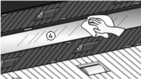
7. Протрите прижимные ролики и ролики подачи ткань, смоченной водой.
