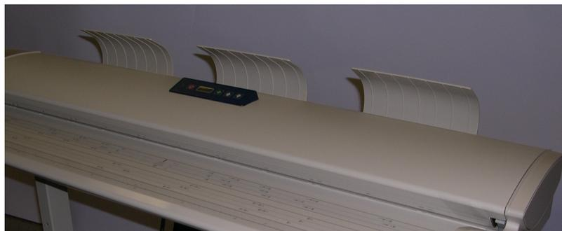
Вставьте три дефлектора вывода материала в соответствующие пазы на верхней кромке в задней части сканера. Убедитесь, что они вставлены в пазы до упора и не закрывают проем для вывода оригинала. Это можно не заметить при их установке.
