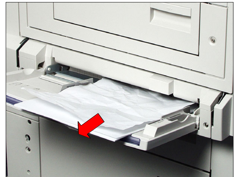
Fig. 6 Bandeja 5 (Manual) Inspeccione o interior (entrada de alimentação do papel) da Bandeja 5 (Manual) e remova o papel atolado.
