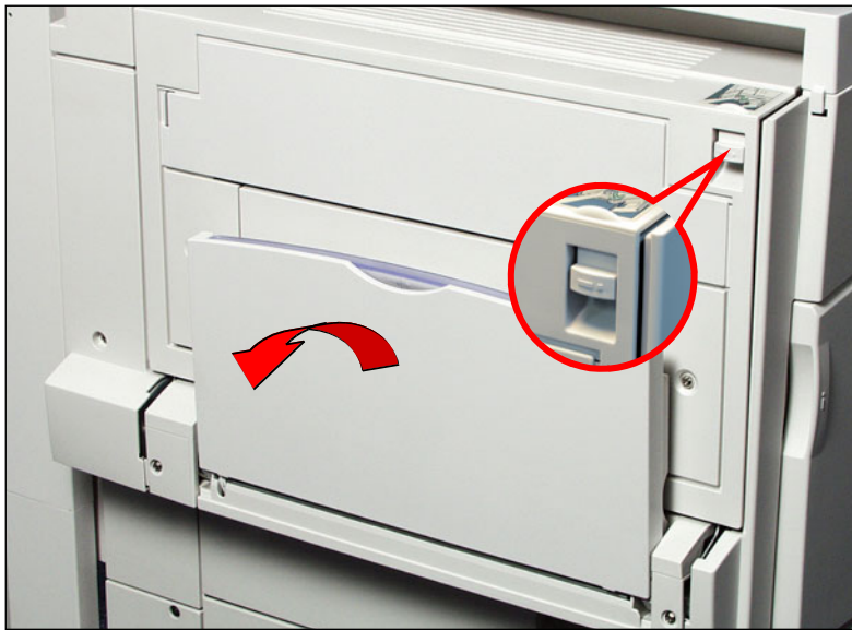
Fig. 1 Tampa superior esquerda Abra a tampa superior esquerda com delicadeza enquanto levanta a alavanca de liberação.
