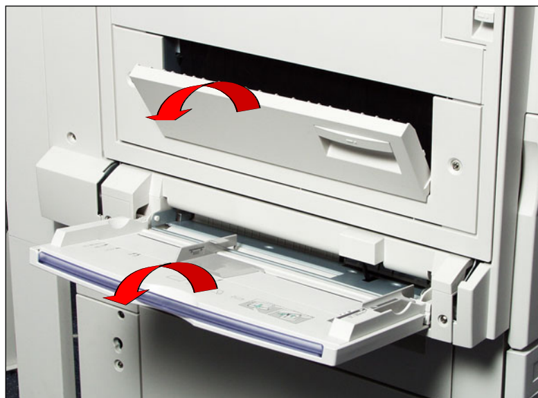
Fig. 4 Tampa do módulo duplex Abra a Bandeja 5 (Manual) e a Tampa do módulo duplex com delicadeza.
