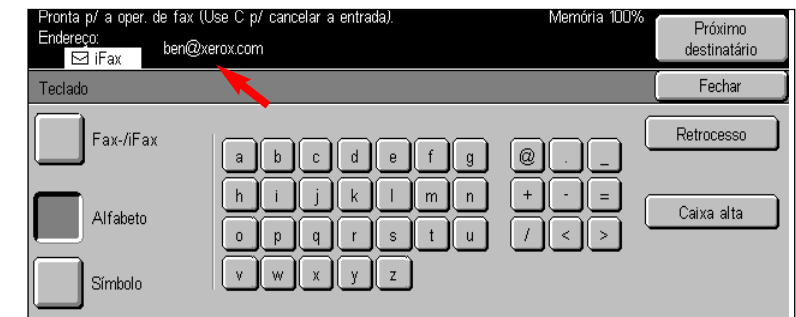
Fig. 2-7 O endereço do destinatário será exibido no campo Endereço no alto da tela.
