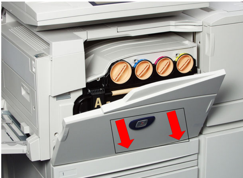
Fig. 1 Assegure-se de que a máquina tenha parado antes de abrir a tampa dianteira.
