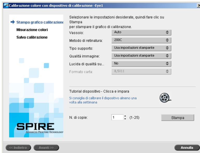
**Suggerimento:** Fare clic sull'icona **Tutorial dispositivo - Clicca e impara** per visualizzare un'animazione del processo di misurazione ed imparare a usare correttamente lo Spettrofotometro Eye-One.
