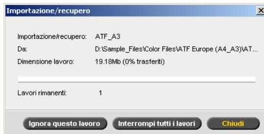
La finestra Importazione/Recupero indica il nome del file che viene importato, la sua posizione e le dimensioni del job. Indica inoltre la percentuale del job già trasferita, sia numericamente che in forma grafica.
