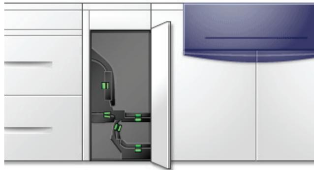
Das Transportmodul transportiert das Papier aus den Papierbehältern zum oberen Papierweg des Digitaldruckers. Beim Duplexdruck transportiert es das Papier auch aus dem unteren Papierweg in den oberen Papierweg des Druckers.
