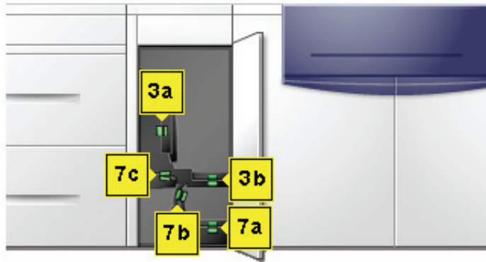
Staubeseitigungsbereiche im Transportmodul
