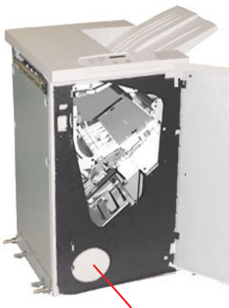
Local da Alavanca de remoção
