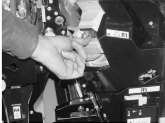
4. Mantenha as posições conforme o indicado pela seta e remova o cartucho de grampos da unidade.
