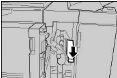
4. Chiudere completamente la copertura sinistra della stazione di finitura. Se la copertura è aperta anche leggermente, la macchina non funziona.
