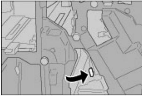
4. Chiudere completamente la copertura destra della stazione di finitura. Se la copertura è aperta anche leggermente, la macchina non funziona.
