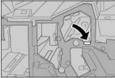
4. Chiudere completamente la copertura destra. Se la copertura è aperta anche leggermente, la macchina non funziona.
