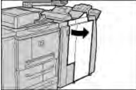
2. Retire a bandeja de saída de dobra tripla 2d, acione a alavanca 2g para a direita e remova o papel atolado.
