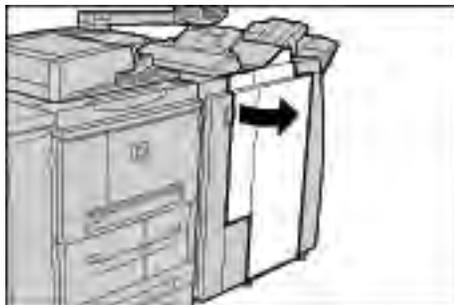
2. Retire a bandeja de saída de dobra tripla 2d, acione a alavanca 2e para a direita e remova o papel atolado.
