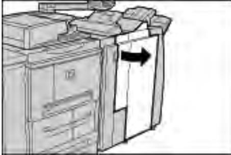
2. Segure o R1 na posição mostrada no diagrama e retire-o da máquina.
