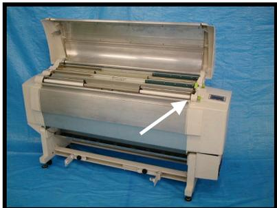
Beim Ersetzen von Materialrollen wird der Freigabehebel auf der rechten Seite des Druckers nicht verwendet und muss in seiner verriegelten Position belassen werden.
