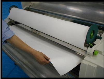
3. Falls der Stau vor der Materialausgabe aufgetreten ist, das Material zum leichteren Abschneiden herausziehen.
