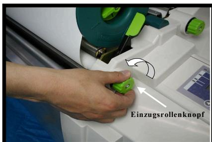
11. Den Einzugsrollenknopf in Richtung der Vorderseite des Druckers drehen. Das Material vorwärts drehen, bis ein akustisches Signal zu hören ist. Der Drucker erkennt die Führungskante des neuen Materials. Sicherstellen, dass das Material gleichmäßig angespannt und faltenfrei ist.
