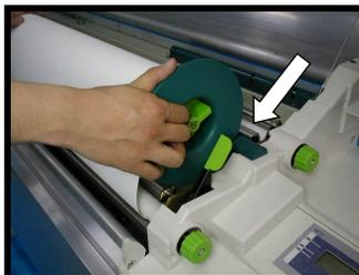
8. Den rechten Endstutzen auf die der Materialbreite entsprechende Position setzen. Die vorderen Führungen sind frei bewegliche Stützrollen.
