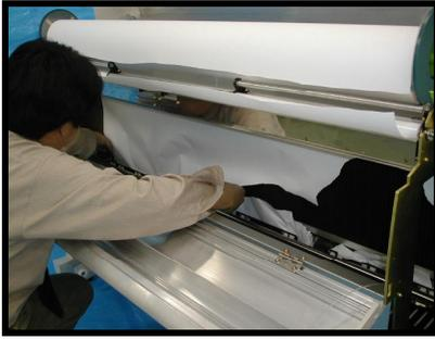
2. Das gestaute Material vorsichtig aus der Schneidevorrichtung entfernen.
