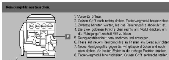
Abb. 41: Aufforderung zum Austausch des Reinigungsfilzes
