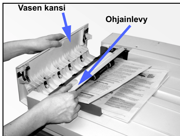
Kuva 7. Vasemman kannen ja ohjainlevyn avaaminen.
