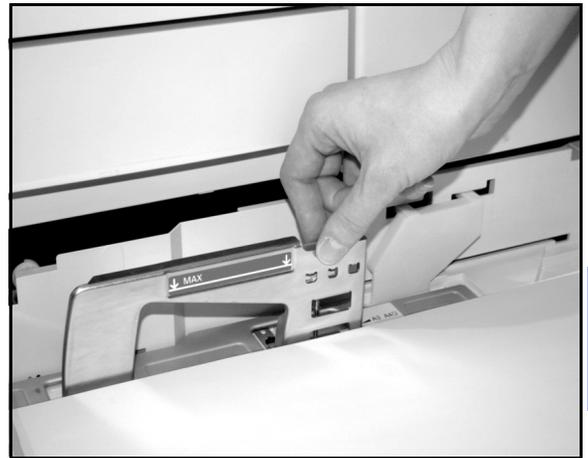
**Figure 7 : Réglage du guide papier arrière**
