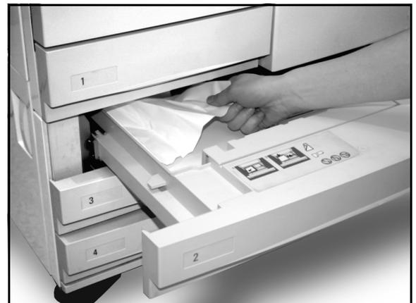
Figure 15 : Résolution d'un incident papier dans un magasin
