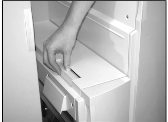
Figure 6 : Bouton de déverrouillage de la trieuse
