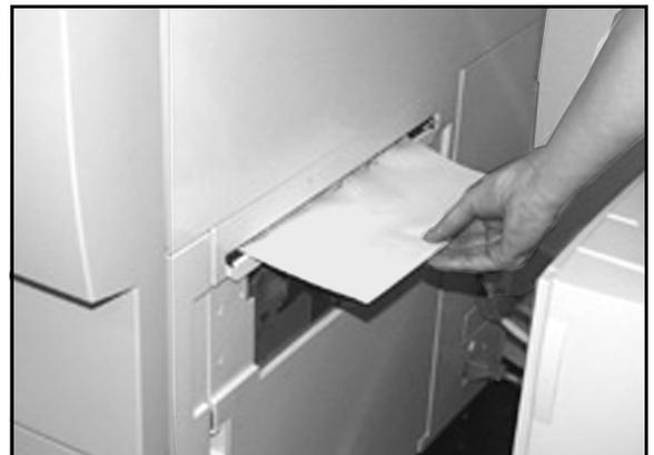
Figure 3 : Retrait d'une feuille coincée entre la machine et la trieuse
