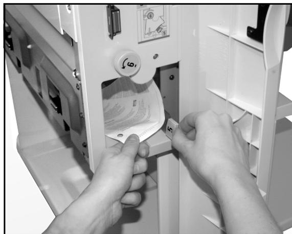
**Figure 4 : Intervention au niveau du panneau avant gauche**
