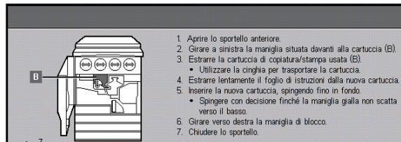
**Fig. 27: Messaggio di sostituzione della cartuccia di copiatura/stampa**
