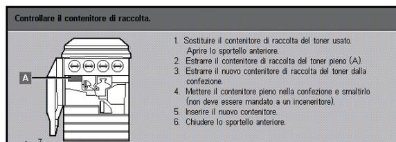
**Fig. 14: Messaggio relativo al contenitore di raccolta del toner usato**
