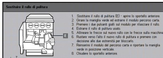
Fig. 41: Messaggio “Controllare rullo di pulitura”
