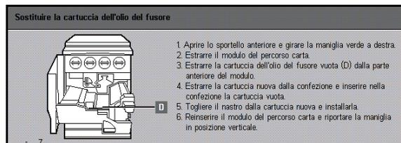
Fig. 34: Messaggio “Controllare l’olio del fusore”
