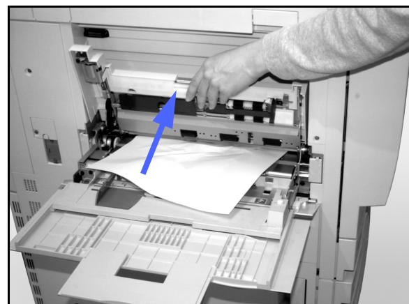
**Figura 5: Apertura del pannello del vassoio 5**
