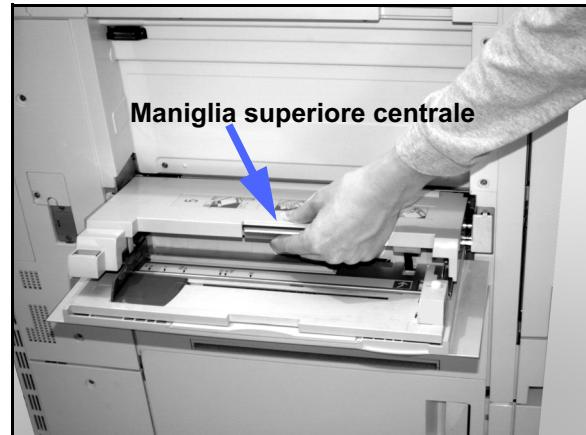
Figura 16: Parte superiore del vassoio 5
