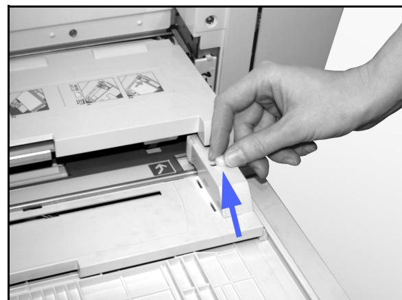
**Figura 14: Guida della carta anteriore e vite di registrazione a testa zigrinata**
