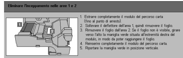
**Figura 3: Una tipica schermata di malfunzionamento**
