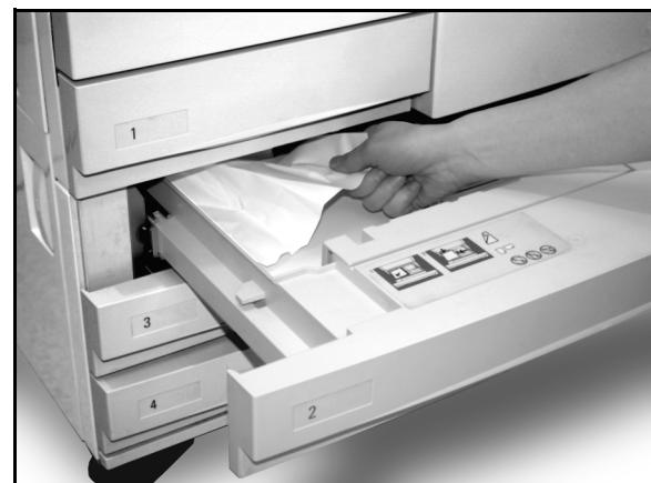
**Figura 15: Eliminazione di un inceppamento all'interno di un vassoio**
