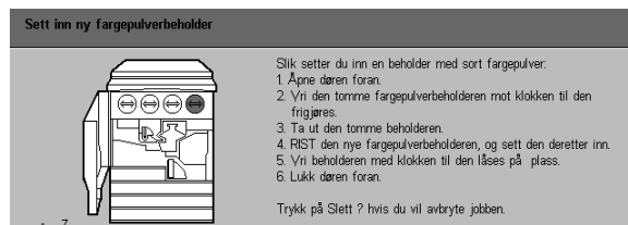
Figur 7: Melding om at fargepulverbekholderen må skiftes
