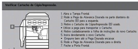
**Figura 27: Mensagem Substitua o Cartucho de Cópia/Impressão**
