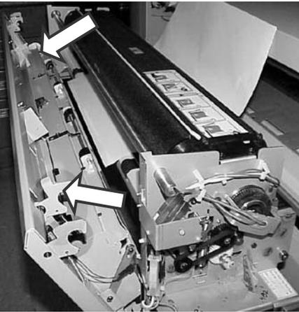
Levante as travas em cada lateral da parte dianteira da gaveta do fusor e abaixe a parte dianteira desta gaveta.
