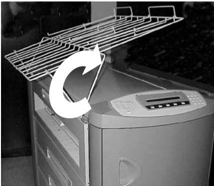
Levante totalmente a bandeja de saída até que ela se apoie na parte superior da impressora.
