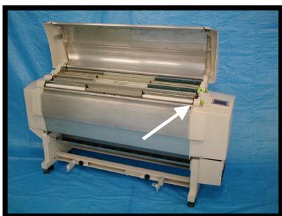
Le levier de dégagement à droite de l'imprimante n'est pas utilisé pour changer les rouleaux de support et doit être laissé en position fermée.
