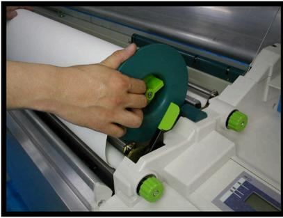
2. Tournez l'embout vers l'arrière pour réenrouler le support sur le rouleau.
