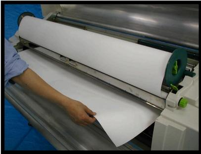
3. Si l'incident s'est produit avant l'éjection du support de la sortie de support, tirez le support pour pouvoir le couper facilement.
