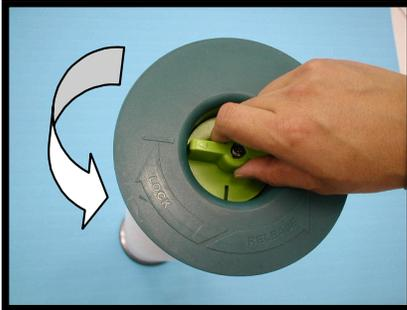
4. Retirez les embouts des deux extrémités du rouleau de support en tournant le bouton de verrouillage vert clair en sens DÉGAGEMENT, puis retirez les embouts du rouleau de support.
