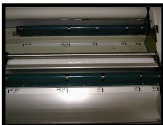
7. Des guides de largeur de support sont fournis sur le chargeur de rouleau de support de l'imprimante.
