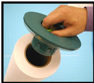
2. Enfoncez un embout dans l'une des extrémités du nouveau rouleau de support en faisant attention de ne pas endommager l'autre extrémité à nu du rouleau de support. L'embout doit être serré mais non pas bloqué sur le rouleau pour assurer l'utilisation optimale.
