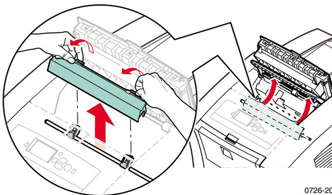
4. Nettoyez délicatement le guide de déverrouillage rapide en l'essuyant avec un chiffon imprégné d'alcool (alcool isopropylique à 90 %).
