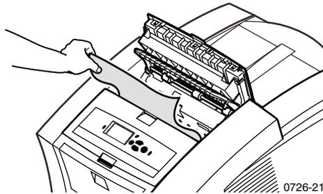
5. Vérifiez que le film transparent anti-poussière est bien situé sur le dessus de l'axe métallique. Remettez ensuite le guide en place, puis appuyez sur les pattes vertes afin de l'encastrer correctement.
