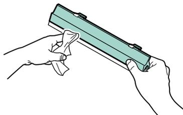
5. Vérifiez si le film transparent anti-poussière est situé sur le dessus de l'axe métallique. Remettez ensuite le guide en place, puis appuyez sur les pattes vertes afin de l'encaster correctement.
