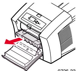
3. 糸屑の出ない布で、メンテナントレイのローラと廃棄インクトレイの間にある柔らかいプラスチック製のワイパークリーニングの上部および上端を拭きます。
