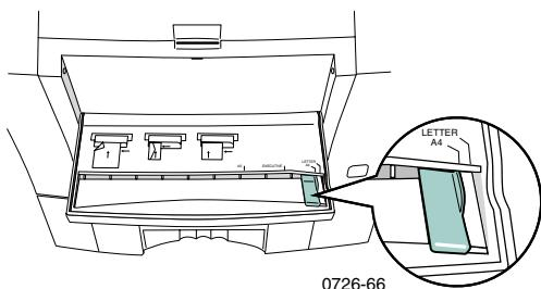
5. フロントパネルに【手差し給紙待ち状態】プロンプトが表示されたとき、1枚の用紙または封筒をプリンタがそれを引き込むまで手差し給紙スロットに挿入します。
